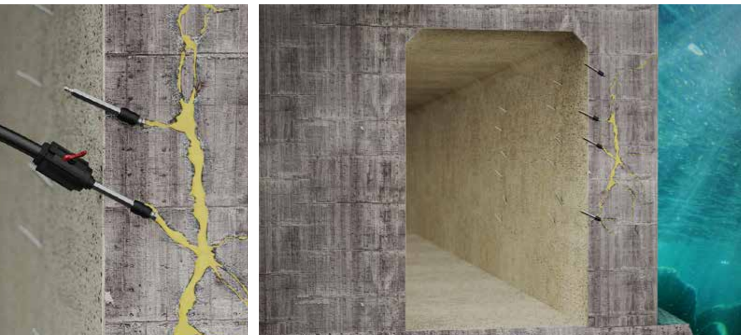
MASTERPUR GEL 2CF32 e MASTERPUR HIDROATIVO 2CF10 foram empregados em larga escala na construção do complexo, que esteve a cargo do Consórcio Construtor Simplício. Ilustração esquemática do processo de injeção.
